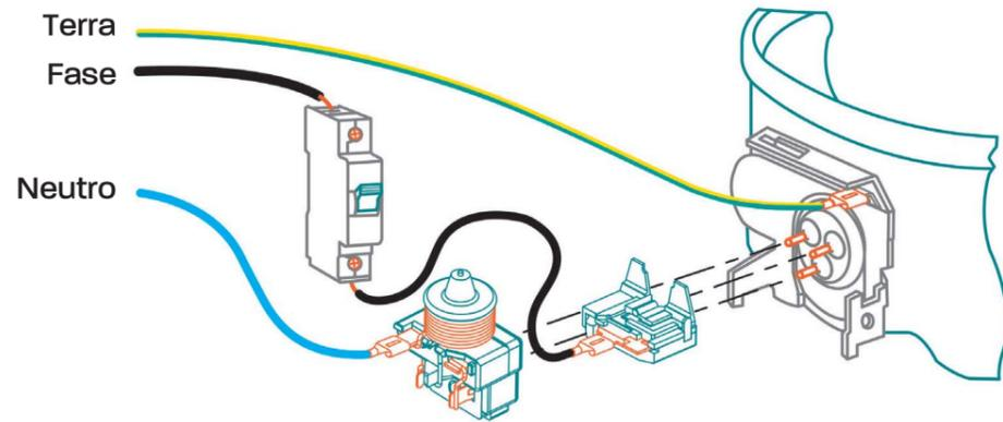
Em instalações monofásicas, o fio Fase deve estar protegido por um disjuntor e conectado ao protetor térmico. O fio Neutro deve estar conectado ao dispositivo de partida (relé ou PTC). O sistema deve estar aterrado.
