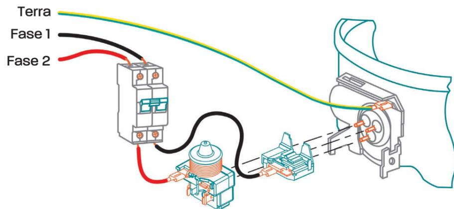
Em instalações monofásicas, o fio Fase deve estar protegido por um disjuntor e conectado ao protetor térmico. O fio Neutro deve estar conectado ao dispositivo de partida (relé ou PTC). O sistema deve estar aterrado.
