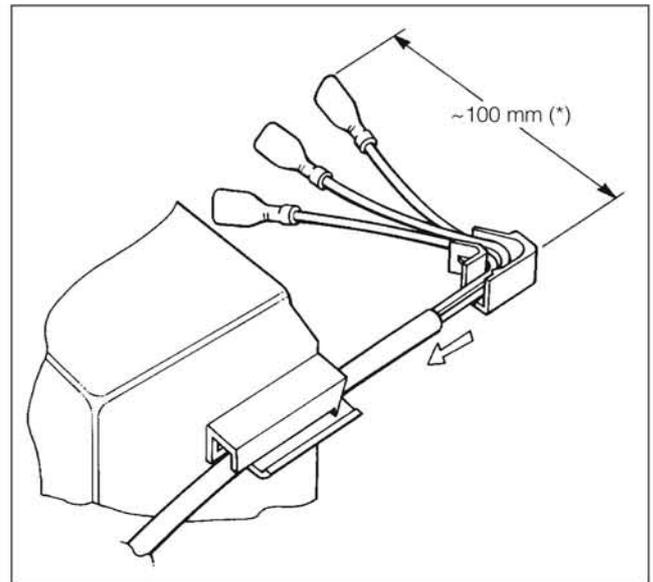
\* O ponto adequado pressupõe que, após montagem do passador de cabos no cabo elétrico, permaneça uma folga entre os terminais do relé e o passador de cabos.
