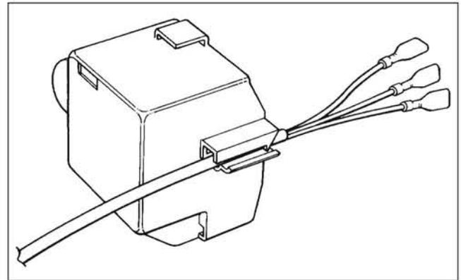
2 - Montar o passador de cabos ao cabo elétrico no ponto adequado\*.
