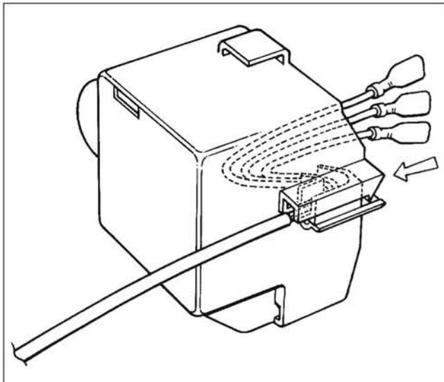
5 - Montar a tampa do relé ao compressor.
