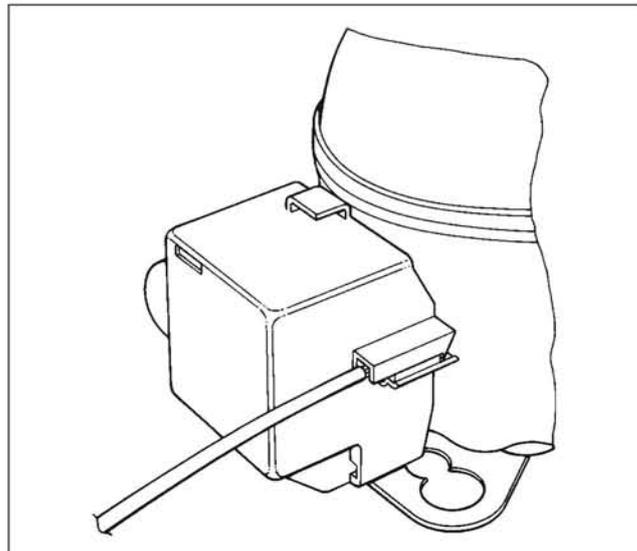
4 - Conectar os terminais do fio fase, neutro e terra do cabo elétrico respectivamente ao protetor térmico, relé e terminal de aterramento do compressor.
