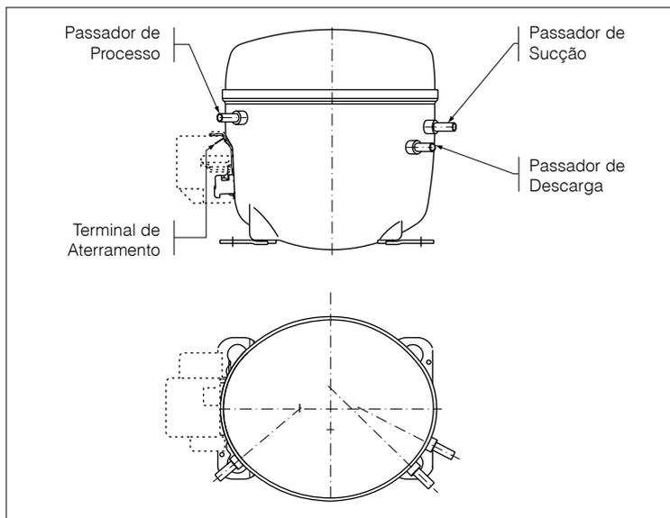
Figura 32 – Compressor F/EG com passadores de cobre
