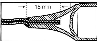
Figura 28 – Introdução do capilar no filtro secador
