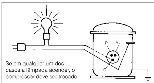
Figura 24 - Teste de enrolamento do compressor PW/F/EG
