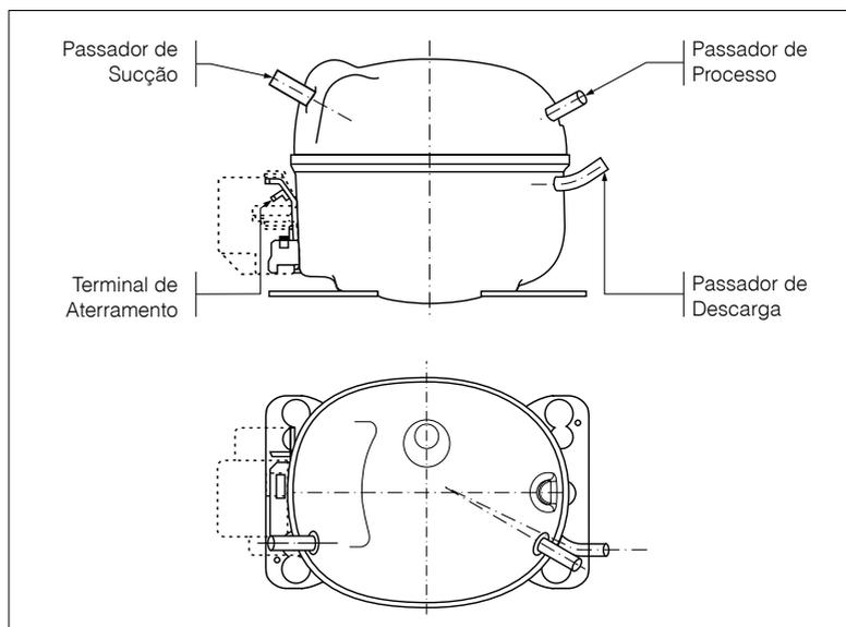
Figura 31 – Compressor EM com passadores de aço cobreado
