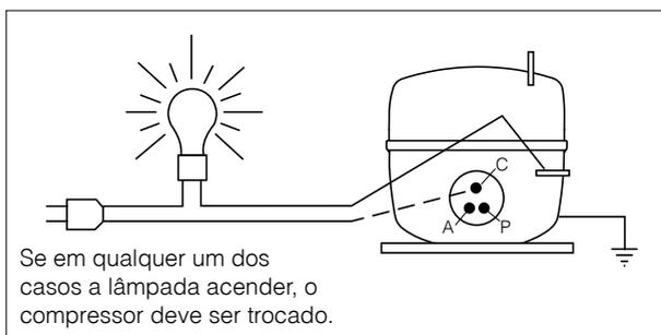
Figura 24.a - Teste de enrolamento do compressor EM
