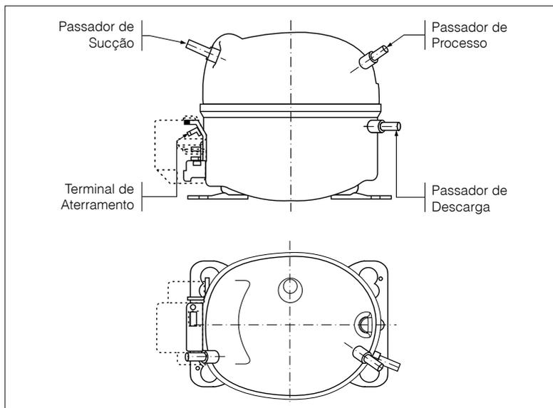
Figura 30 – Compressor EM com passadores de cobre
