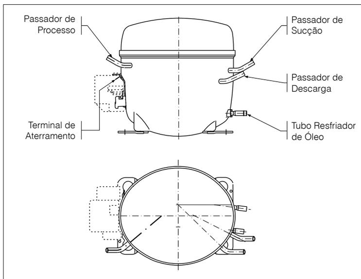
Figura 33 – Compressor F/EG com passadores de aço cobreado
