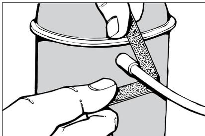
Figura 26.a – Operação de lixamento do passador
