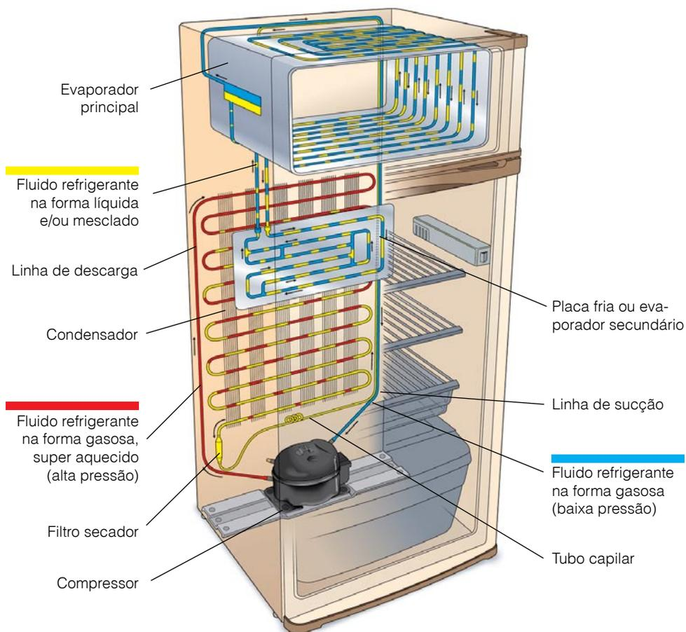
Figura 1 - Funcionamento de um sistema básico de refrigeração
