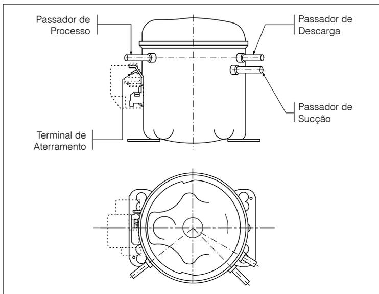
Figura 34 – Compressor PW com passadores de cobre
