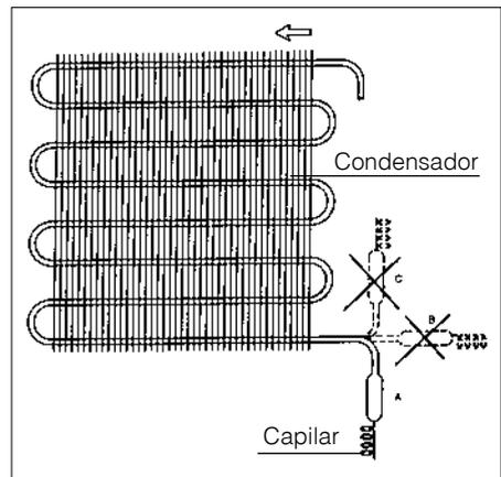
Figura 29 - Filtro secador
