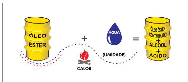
Figura 42 – Reação química entre óleo éster e umidade
