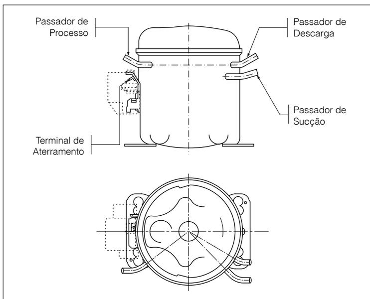
Figura 35 – Compressor PW com passadores de aço cobreado
