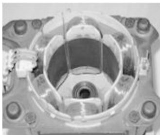
Estator com enrolamento de cobre
