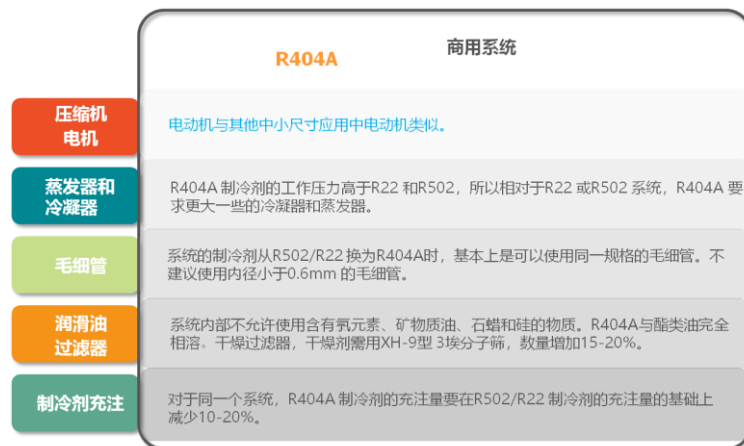
图 1 替换为 R404A 的制冷系统调整
