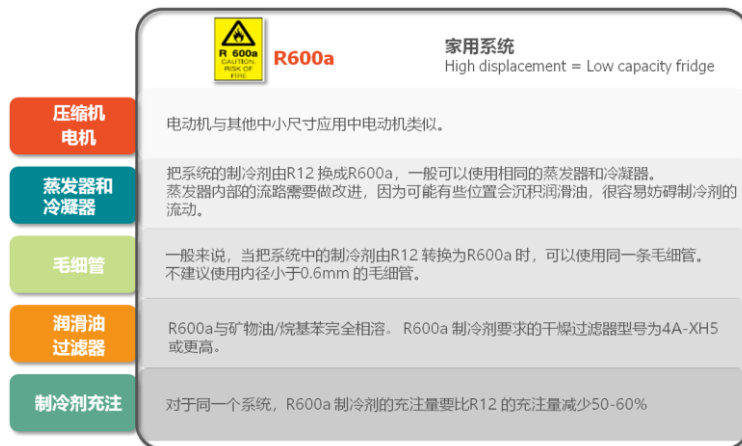
图 3 替换为 R600a 的制冷系统调整
